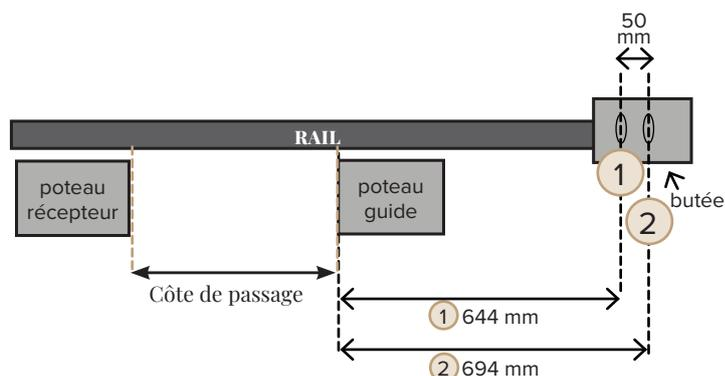
**Calcul pour les positions de perçages des trous 1 et 2 de la butée :**
