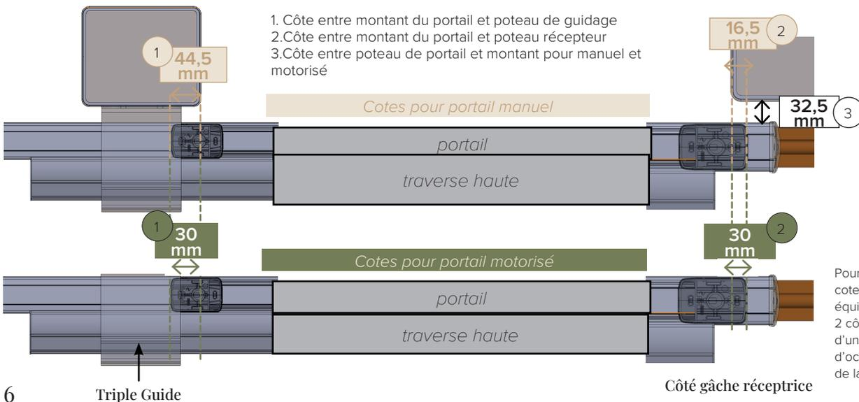
Pour le portail motorisé, les cotes sont différentes pour équilibrer le recouvrement des 2 côtés. Il s'agit uniquement d'une question d'esthétique et d'occulter davantage le côté de la serrure.
