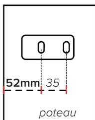
52mm du bord du poteau et 88mm du bord du poteau, du côté du portail qui fonctionne. Soit un entraxe de 35mm entre les deux perçages.
