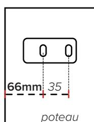
66mm du bord du poteau et 101mm du bord du poteau, du côté du portail qui fonctionne. Soit un entraxe de 35mm entre les deux perçages.
